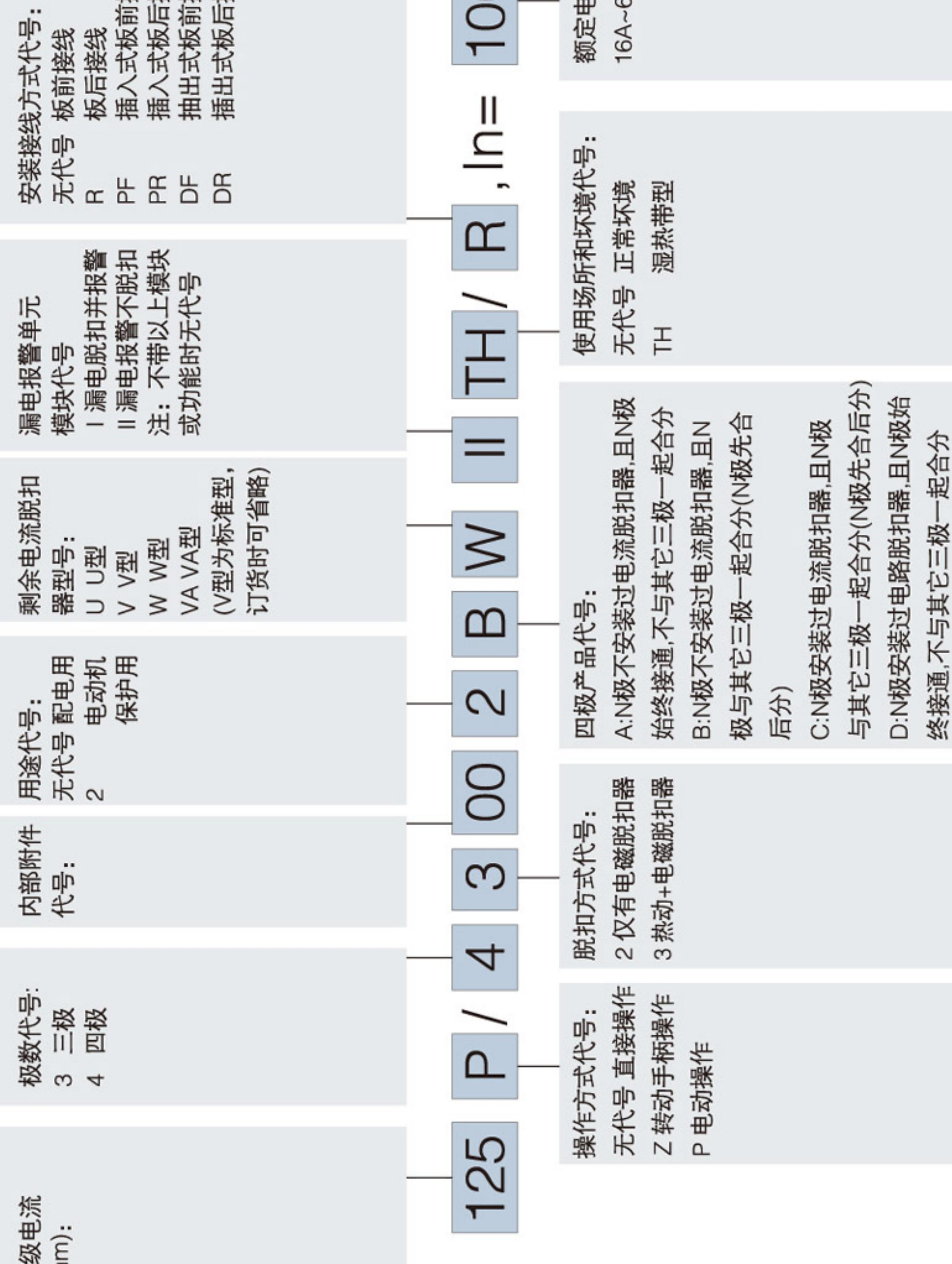
举例: 如订ZAM3L-125,四级,额定电流为80A并带电动操作机构及辅助开关, N极不安装过电流脱扣器,且N极始终接通,不与其它三极一起合分,板前接线5台,即写为订ZAM3L-125P/4320A 80A 5台。
